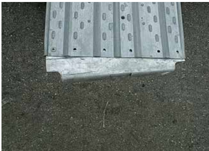
Scaffold Decks UDS / UDI / UDG ■ defective rivets
