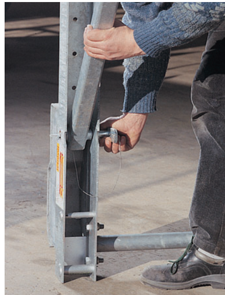
Trykstangen fastgøres med de fastmonterede bolte.
