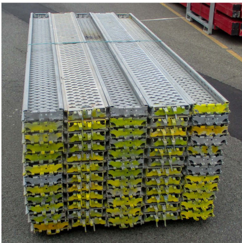
PERi UP stilladsdæk (125 cm+) pakkes på strøer med 5 i bredden og maks. 12 stk. i højden. Båndes for sikker transport.
