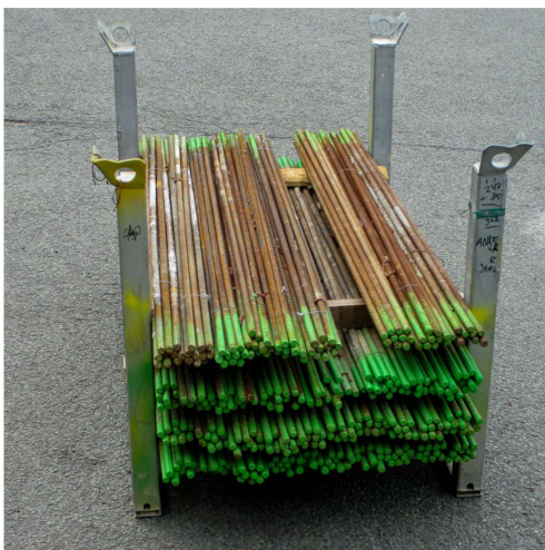
Ankerstave 1,5 m + pakkes i lille Barelle Ankerstave maks. 1 m pakkes i lille Kasse Barelle eller i Gitterboks. Anvend ståltråd for at samle i bundter for sikker transport.
