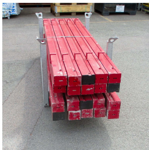
MAXIMO tilpasningsstykker pakkes i Stor Barelle. Anvend strøer imellem hvert andet lag.
