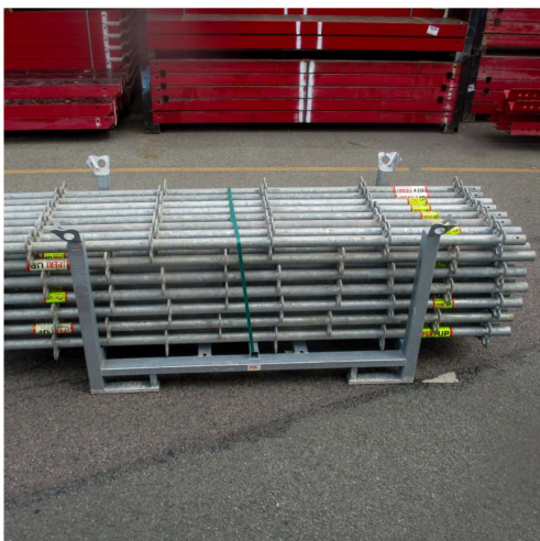
PERi UP Vertikalsøjler (125 cm+) pakkes i lille Barelle eller Stor Barelle med 8 stk. i bredden og maks. 7 stk. i højden. Båndes for sikker transport.
