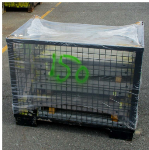
PERi UP horisontaler, vertikalsøjler og diagonaler samt andet tilbehør (maks 120cm) pakkes i Gitterboks.
