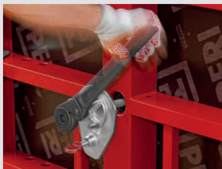
Gänga in Formstag MX med Formstagsnyckel MX tills det tar stopp i öglebulten.
